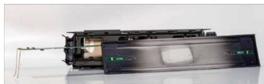
Die Perronbeleuchtungen sind probeweise ins Dach eingesetzt und die Kontaktfahnen für den Einbau bereits abgewinkelt. - Fotos (3): Manfred Hofmann
