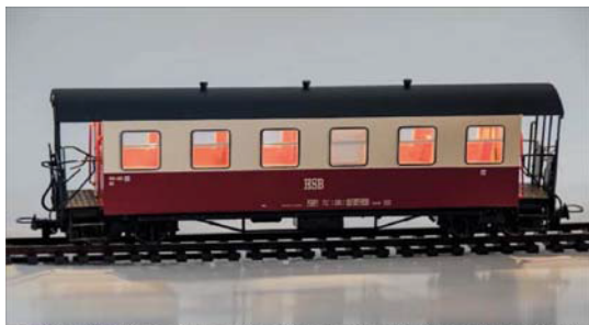
Die Wagenbeleuchtung mit warmweißen LEDs gibt auch auf den Perrons eine dem Vorbild entsprechende Lichtstimmung wieder.
