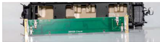
Gut sichtbar sind die im Wagenoberteil befindlichen Halterungen und Führungsschlitze für die Kontaktfahnen zur Stromaufnahme.
